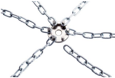
III. 15: Chaînes fixées sur la pièce de serrage.
