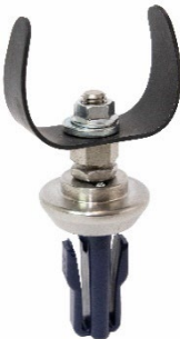
Abb. 8: Fräskopf Vogelnest montiert auf Stoßkopfadapter Leinstern
