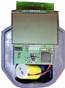
Fig. 68: Remplacement de la pile
