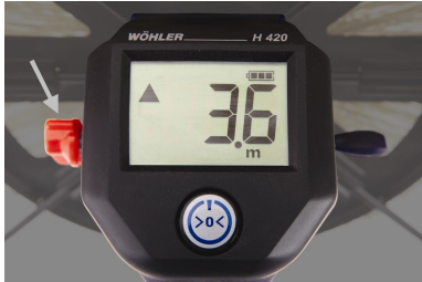
Fig. 61: Vis à poignée-étoile pour ajuster le frein à roue libre
