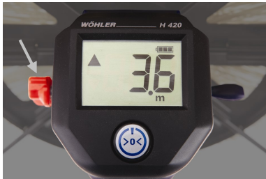
Abb. 10: Sterngriffschraube zum Einstellen der Freilaufbremse
