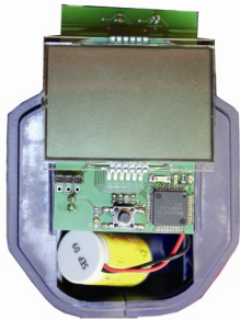
Imm. 51: vano pile
