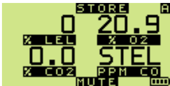
Fig. 4-5 CO STEL Alarm
